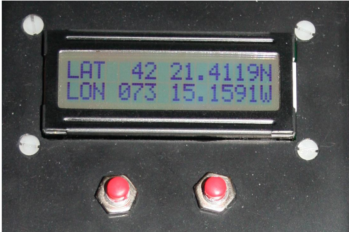
Figure 1 - 3DfixLCD displaying latitude and longitude from NMEA data.
